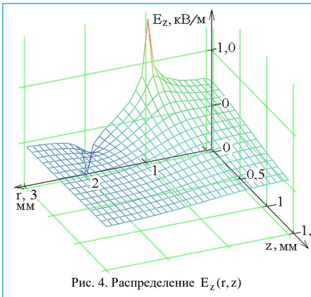
Поскольку воздействие диэлектрической проницаемости на ЭМП резонатора передается через электрическую компоненту поля, то результат внешнего воздействия на образец со стороны, противоположной экрану, можно будет оценить уже на расстоянии 0,8...1,0 внешнего радиуса апертуры.
